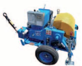
Die Kabelziehwinde KZW-H 10 ist kompakt gebaut. Sie ist vielseitig und dank der kurzen Rüstzeit stets schnell einsetzbar. Die Zugkraft wird über die Trommel erzeugt. Geschwindigkeit und Drehrichtung können zu jeder Zeit problemlos über das Bedienfeld verändert werden.
